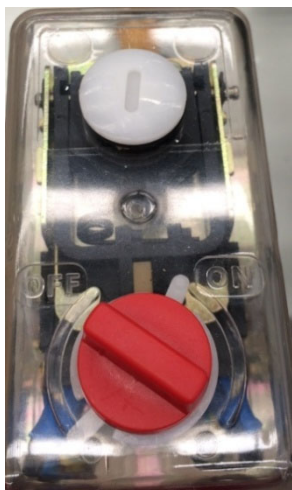
Переключатель управления давление в положении ВЫКЛ.
